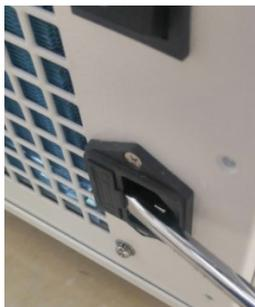
Apague el aparato y desconecte el cable de alimentación. Levante la tapa del portafusibles con un destornillador plano. Retire el fusible y compruebe si se ve algún apagón. En caso afirmativo, sustituya inmediatamente el fusible.
